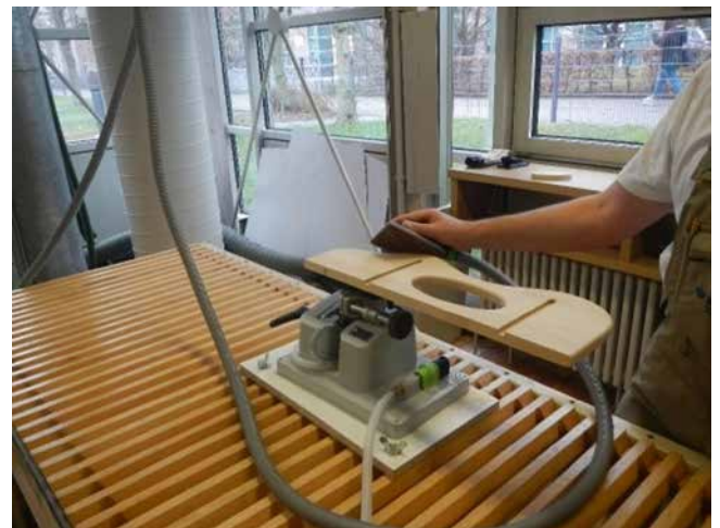
Abb. 30 Arbeiten mit dem abgesaugten Handschleifklotz auf einem abgesaugten Arbeitstisch
