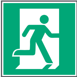
E002 Rettungsweg/ Notausgang (rechts)**
