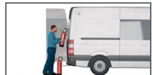
Eingesetzte Feuerlöscher nicht mehr aufhängen und neu füllen lassen
