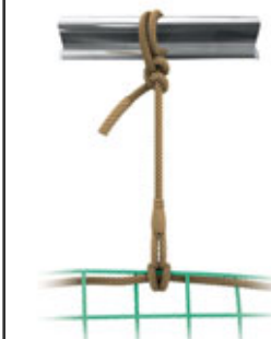
a) Einsträngiges Aufhängeseil L (Seilbruchkraft \geq 30 kN)
