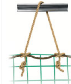
b) Zweisträngiges Aufhängeseil Z (Seilbruchkraft \geq 15 kN)
