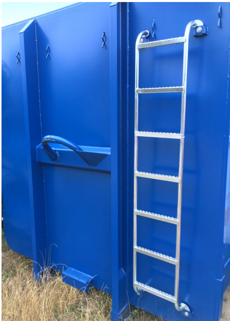
Abb. 30 Sicher begehbarer Aufstieg am Behälter
