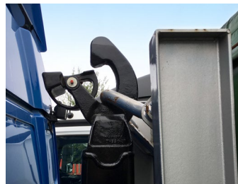
Abb. 8 Aufnahmehaken mit Schwerkraftsicherung
