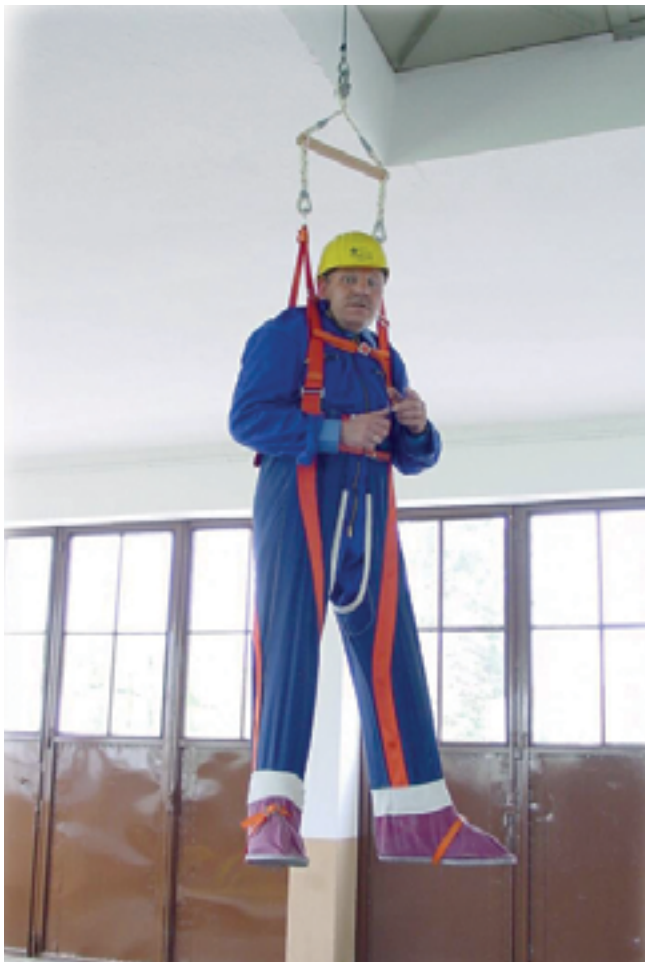
Abbildung 18: Silohose als Teil einer Siloeinfahreinrichtung
