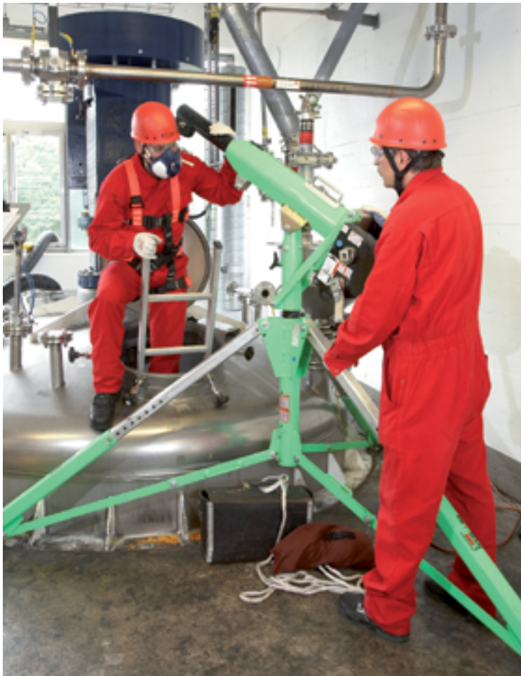
Abbildung 15: Einsteigen in einen Rührbehälter
