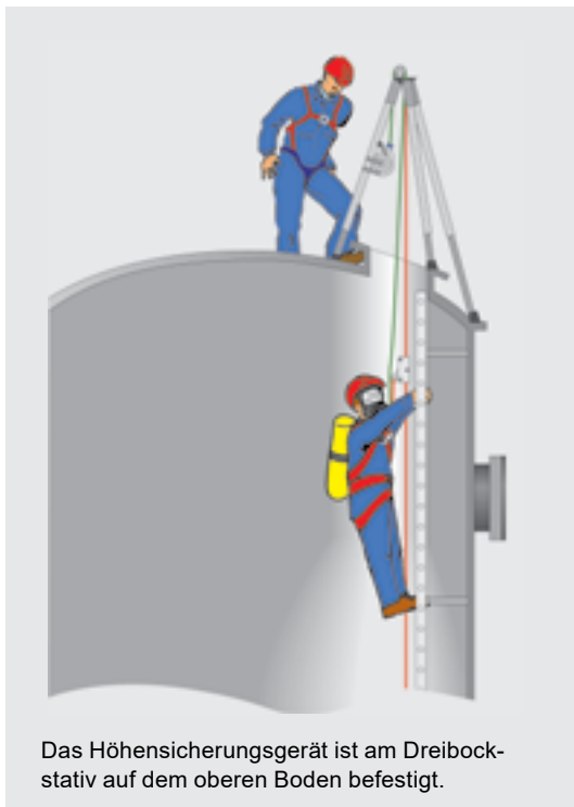
Abbildung 12: Höhensicherungsgerät mit Rettungshub (grün) als Schutz gegen Absturz und Rettungsgerät, mitlaufendes Auffanggerät (rot) als Zweitsicherung
