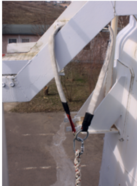
Abbildung 42: Schlinge mit Kantenschutz-Überzug (sogenannte Scharfkantenschlinge)
