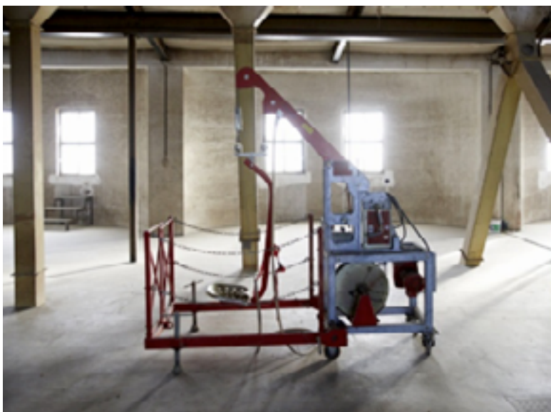
Abbildungen 19 und 20: Siloeinfahrereinrichtungen mit Arbeitssitz
