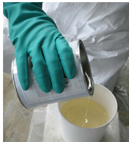
Abb. 12.5 Umfüllen der Harzkomponente aus einer Dose in die Mischvorlage
