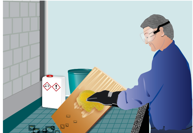
Abb. 12.3 Mitarbeiter trägt Bleichmittel mit einem Schwamm auf das Werkstück auf
