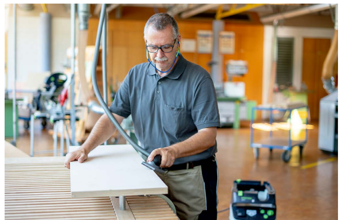
Abb. 12.6 Tischler bearbeitet Werkstück mit einem abgesaugten Handschleifklotz
