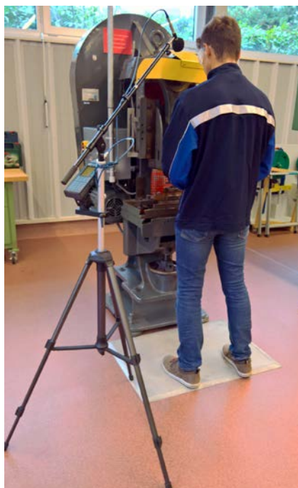
Abb. 13 und 14 Schallpegelmesser mit Stativ bei ortsfester Messung in Abwesenheit und in Anwesenheit eines Beschäftigten
