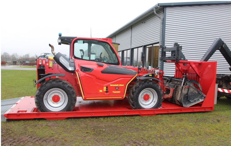
Abb. 8.10 Transport mit Abrollpritsche (Zurrmittel noch nicht angebracht)
