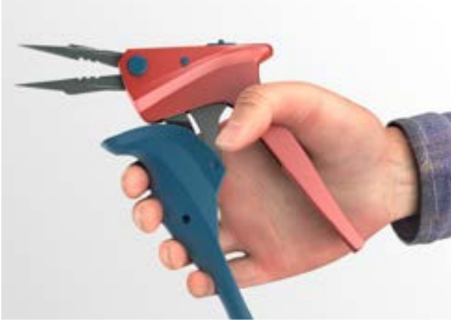
Abb. 27 Ergonomisch gestaltete Zange
