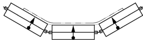
Abb. 13 Auflaufstellen an gemuldetem Gurtförderer (Querschnitt) (DIN EN 620)
