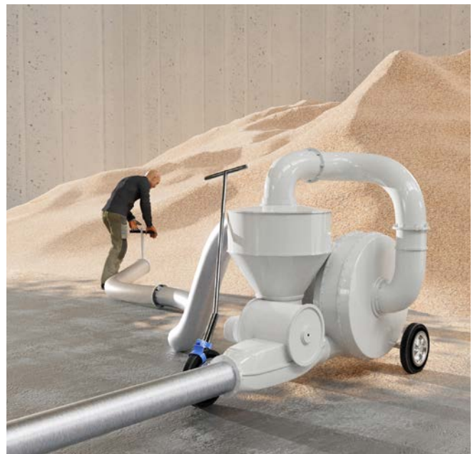
Abb. 6 Pneumatischer Förderer für Getreide
