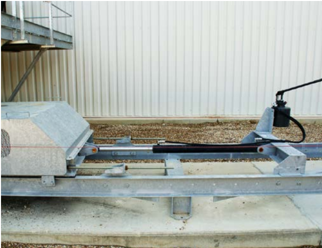
Abb. 22 Spanneinrichtung mit Verstellmöglichkeit von außen
