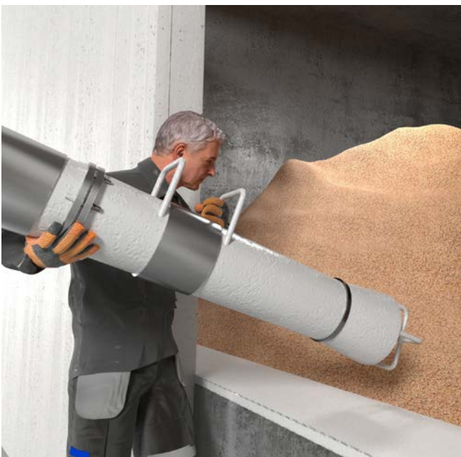
Abb. 37 Einlassöffnung eines Saugrohres durch Stäbe begrenzt
